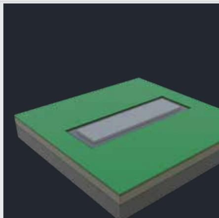
Coulez une base en béton pour l'ensemble de modules. Assurez-vous que la base en béton soit bien plane.
