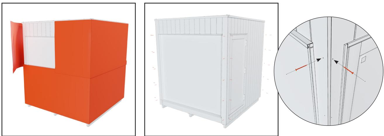
9. Ta bort det vita förpackningsskyddet. Sätt tillbaka de bruna skruvarna som höll hörnplåtarna på plats i hörnpanelerna.
