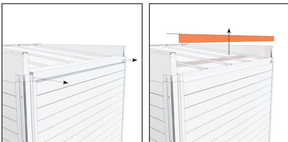
3. Rimuovere la lamiera dal bordo posteriore del tetto. È fissato con due viti su entrambe le estremità.
