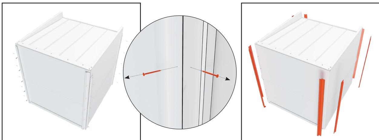
6. Verwijder de metaalplaten van de hoeken. De metaalplaten zitten vast met 55 à 6 schroeven.
