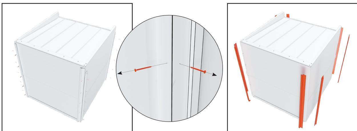
6. Poista peltiosat kulmista. Peltiosat on kiinnitetty 5-6 ruuvilla.
