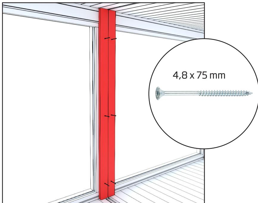
6. Platzieren Sie die Leiste an der Vorderwand zwischen den Modulen und befestigen Sie sie mit sechs Schrauben. Die Leiste hat vorgebohrte Löcher.
