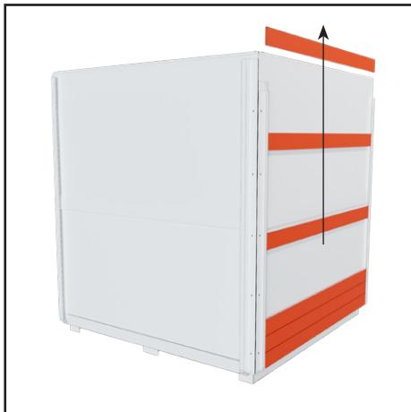
5. Verwijderen van de borden. Een aantal bovenliggende borden (4 à 6) moet recht omhoog worden getild en verwijderd. De rest kan u er diagonaal afhalen.
