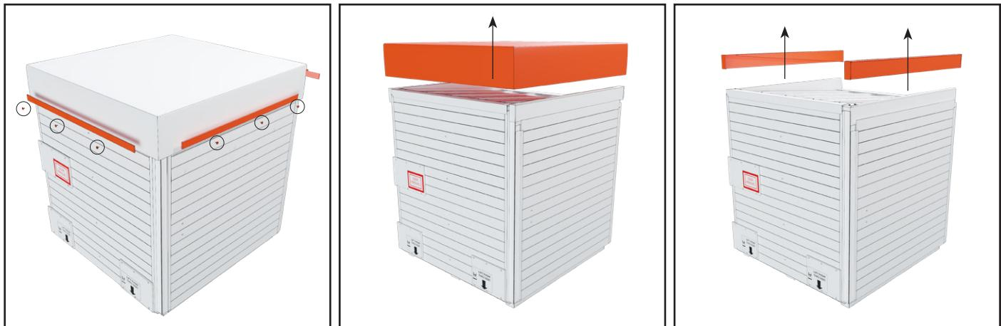
1. Entfernen Sie die Schrauben der Dachhaube und heben Sie die Haube ab. Heben Sie die Sperholzelemente vom Dach ab.
