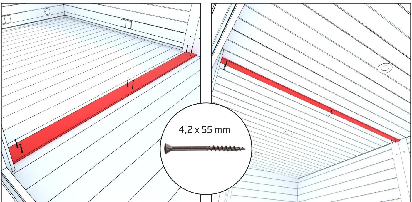
7. Asettele lista lattialle moduulien väliin ja kiinnitä kuudella ruuvilla. Listassa on ruuvin reiät valmiina.
