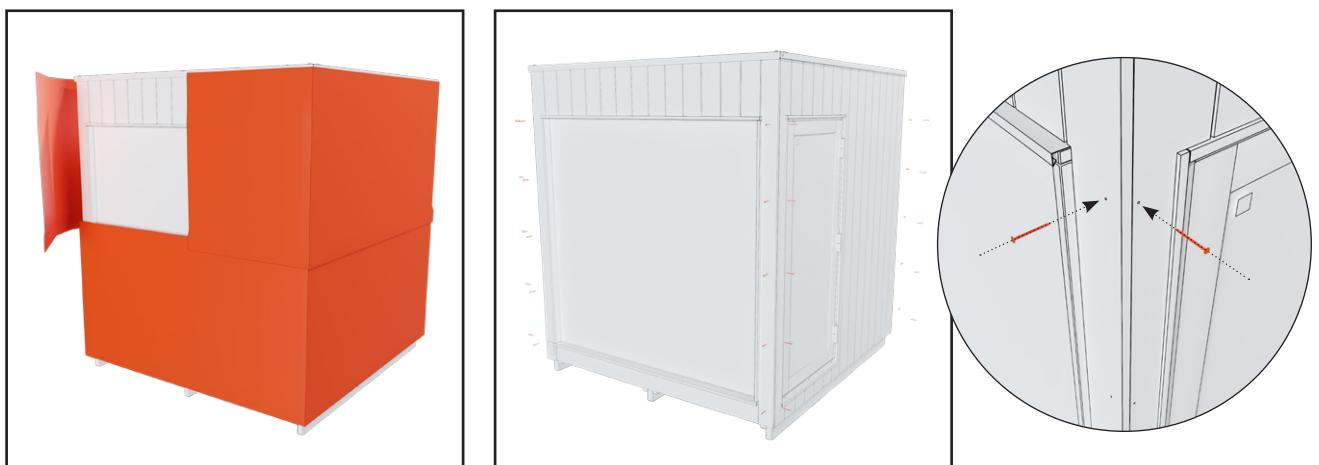
9. Poista valkoinen pakkaussuojuus. Laita ruskeat ruuvit, joilla kulmapellit oli kiinnitetty, takaisin kulmapaneeleihin.
