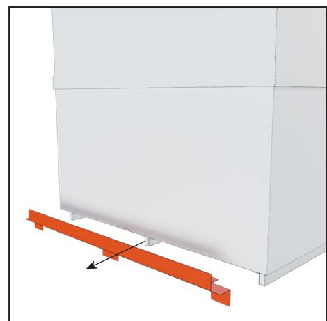
7. Rimuovere la lamiera dalla parte anteriore inferiore del modulo. La lamiera è fissata con sei viti
