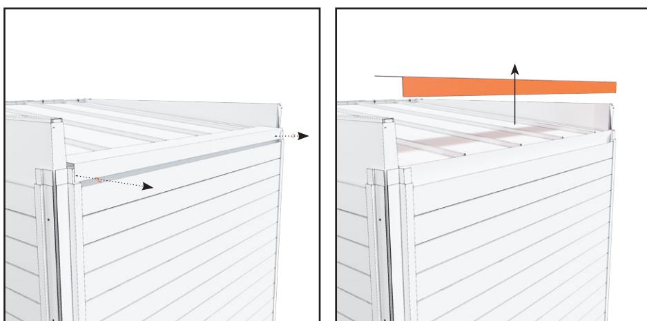
3. Entfernen Sie das Blech an der Hinterkante des Daches. Es ist an beiden Enden mit zwei Schrauben befestigt.
