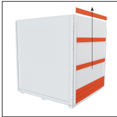
5. Retrait du bardage. Quelques planches supérieures (4-6) doivent être glissées vers le haut pour être retirées. Les autres peuvent être retirées en diagonale.
