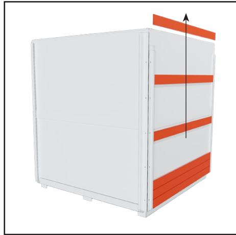
5. Entfernung der Verkleidung. Einige obere Bretter (4-6) müssen gerade nach oben gehoben und entfernt werden. Der Rest kann diagonal entfernt werden.
