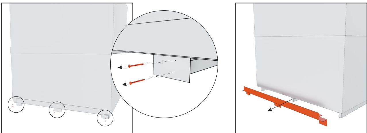
7. Verwijder de metaalplaat van de voorste bodem van de module. De metaalplaat zit vast met zes schroeven.
