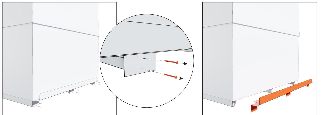
8. Verwijder de metaalplaat van de achterste bodem van de module. De metaalplaat zit vast met zes schroeven.
