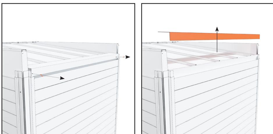
3. Ta bort plåten från takets bakkant. Den är fäst med två skruvar i varje ände.
