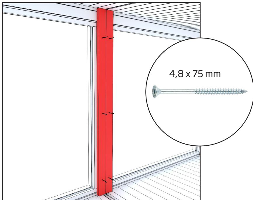
6. Placez la bande sur la paroi avant entre les modules et fixez-la à l'aide de 6 vis. Des trous sont déjà préforés dans la bande.
