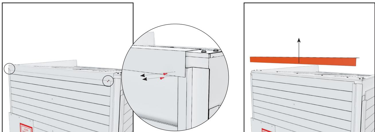
2. Ta bort plåten från takets framkant. Den är fäst med två skruvar i varje ände.
