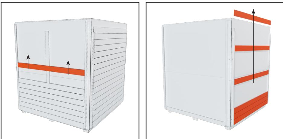
5. Laudoituksen poistaminen. Muutamat ylälaudat (4-6) täytyy nostaa suoraan ylöspäin ja poistaa. Loput voidaan poistaa vinosti.
