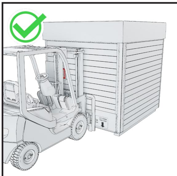
Guidare il carrello elevatore sotto il modulo
