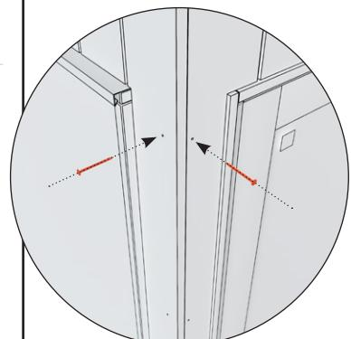
9. Entfernen Sie den weißen Verpackungsschutz. Setzen Sie die braunen Schrauben, mit denen die Eckbleche befestigt waren, wieder in die Eckpaneele ein.
