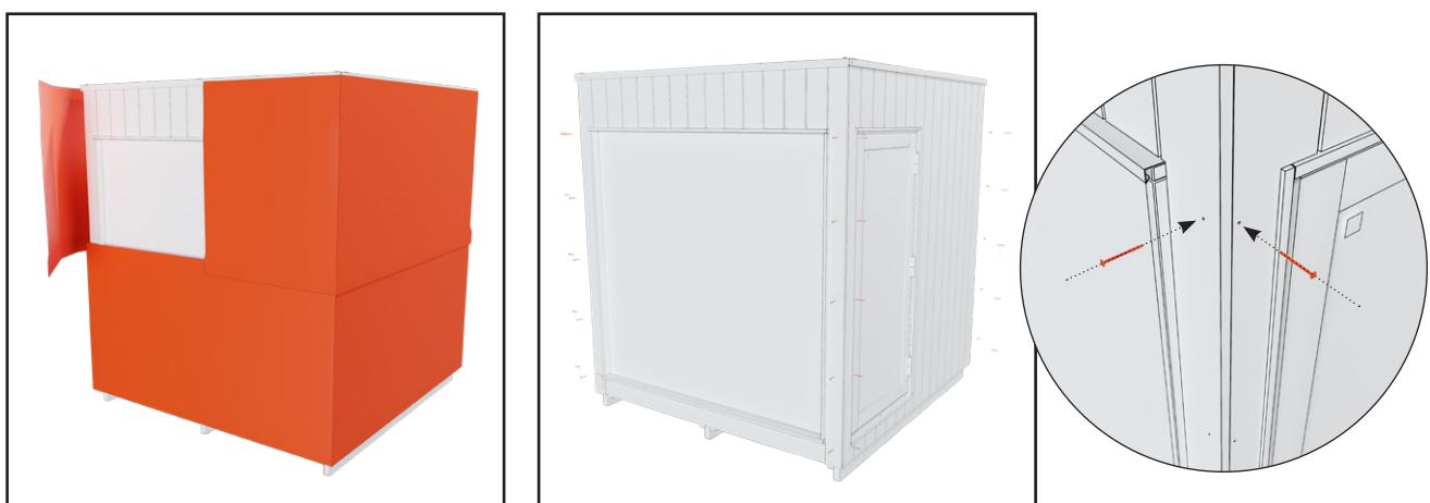
9. Verwijder het witte beschermingsmateriaal. Steek de bruine schroeven waarmee de metaalplaten op de hoeken vastzitten, terug in de hoekpanelen.
