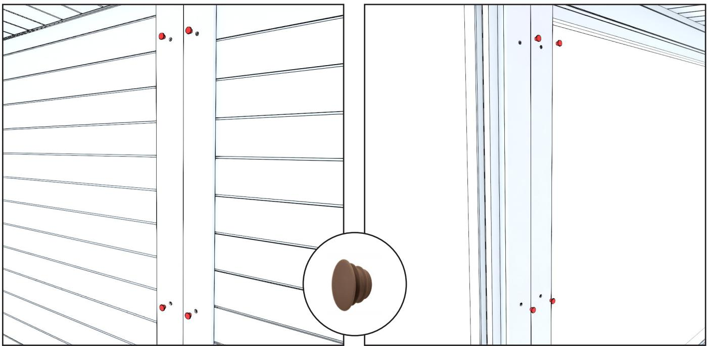
9. Stecken Sie die Ppropfen in die Schraublöcher im Boden, in der Rückwand und in der Vorderwand.
