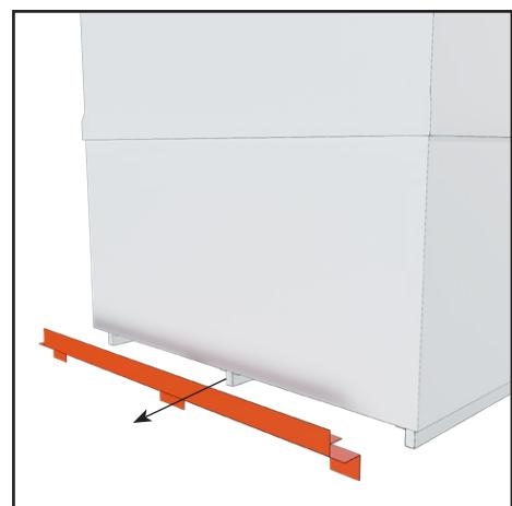
7. Entfernen Sie das Blech an der vorderen Unterseite des Moduls. Das Blech ist mit sechs Schrauben befestigt.
