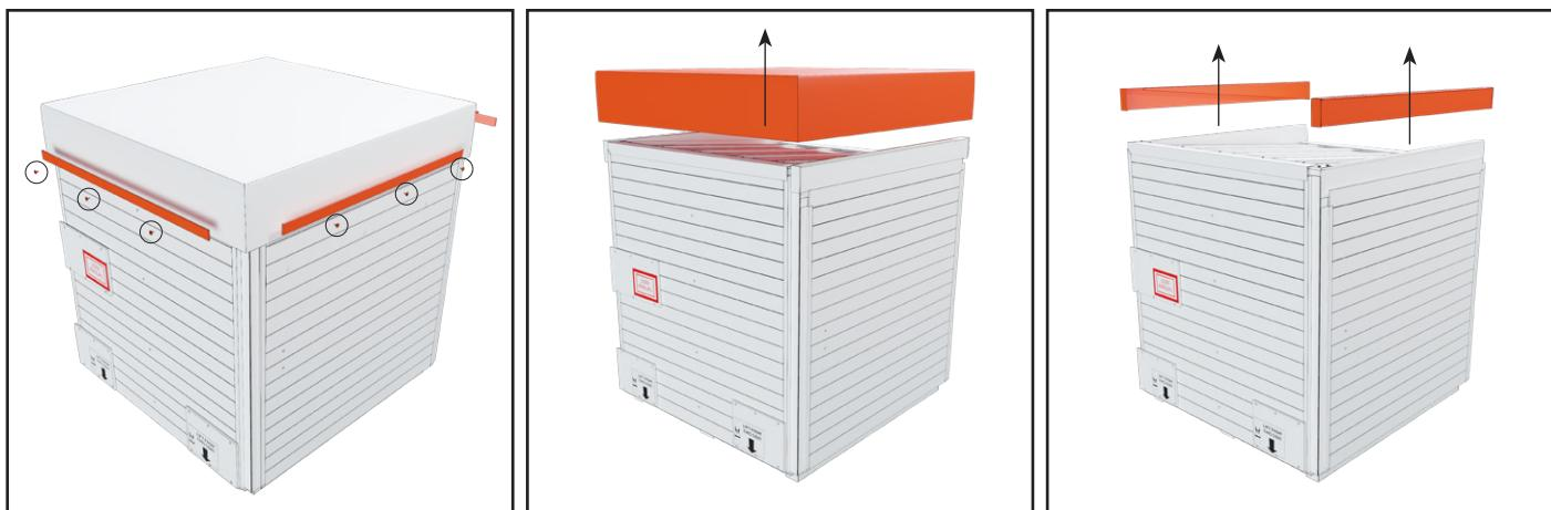
1. Rimuovere le viti del rivestimento del tetto e staccarlo. Sollevare le casse di compensato dal tetto.
