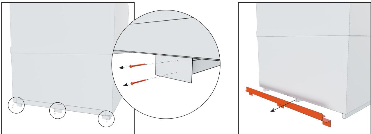
7. Ta bort plåten från modulens främre nedre kant. Plåten är fäst med sex skruvar.
