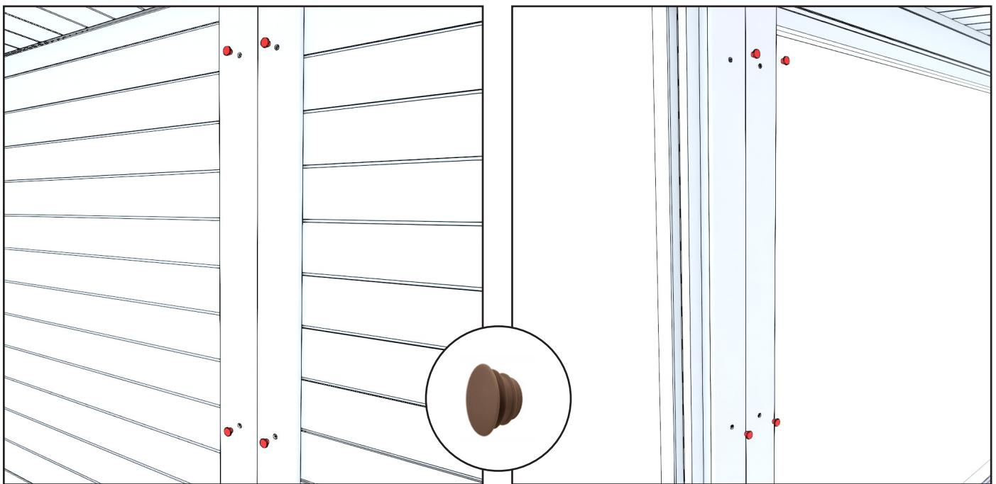
9. Mettez les bouches dans les trous des vis sur le sol, la paroi arrière et la paroi avant.
