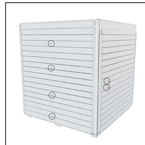
4. Entfernen Sie die Schilder von der Verpackung. Entfernen Sie alle Schrauben von den Brettern. Diese Schrauben halten die Stützen im Inneren der Bretter in Position.
