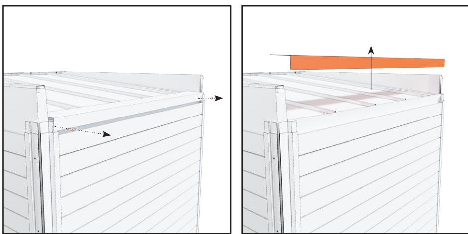
3. Retirez la plaque en métal du bord supérieur arrière du toit. Elle est fixée à l'aide de deux vis à chaque extrémité.
