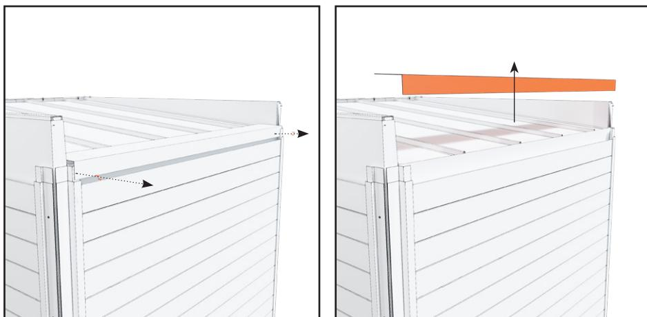
3. Poista pelti katon takareunasta. Se on kiinnitetty kahdella ruuvilla kummastakin päästä.
