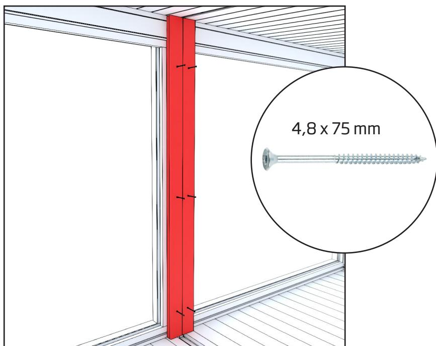
6. Asettele lista etuseinälle moduulien väliin ja kiinnitä kuudella ruuvilla. Listassa on ruuvin reiät valmiina.
