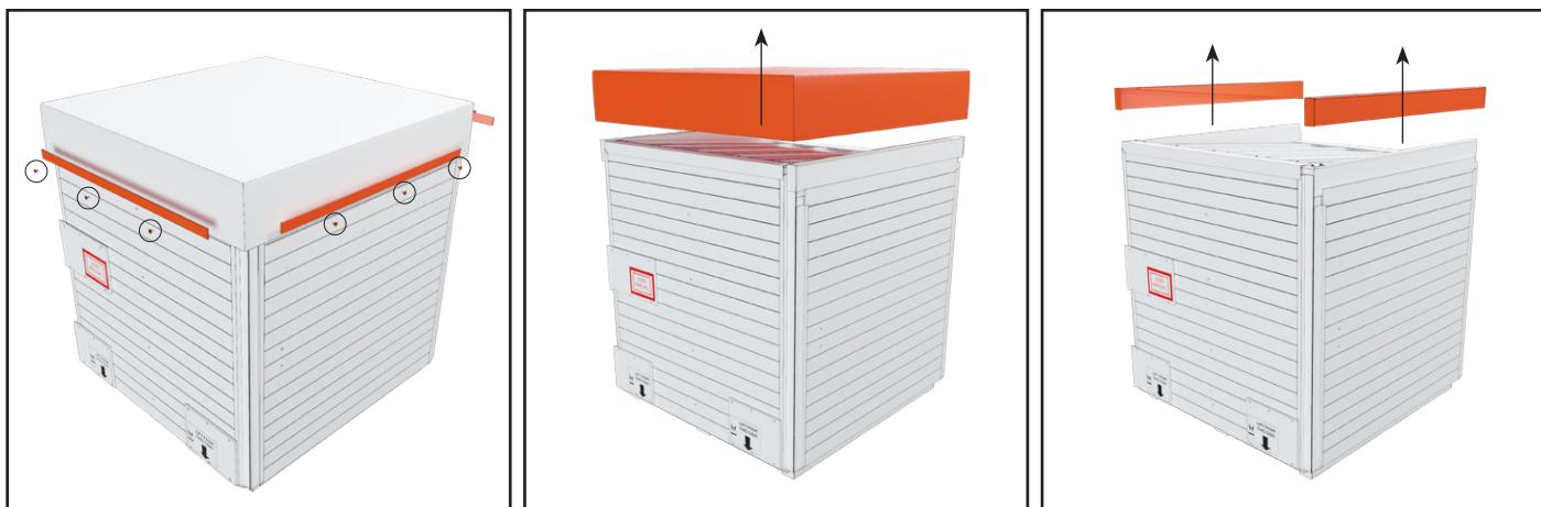
1. Poista katon hupun ruuvit ja nosta huppu pois. Nosta vanerilaatikot pois katolta.
