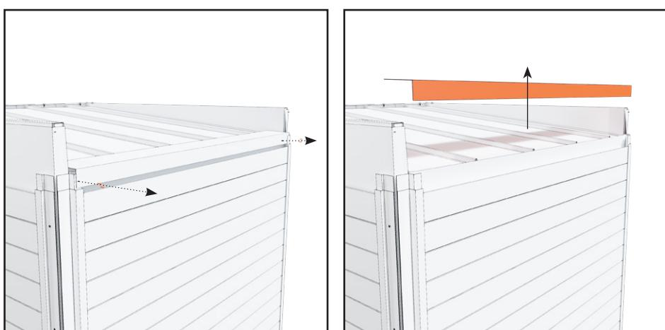
3. Verwijder de metaalplaat van de achterste rand van het dak. Deze is aan beide uiteinden bevestigd met twee schroeven.
