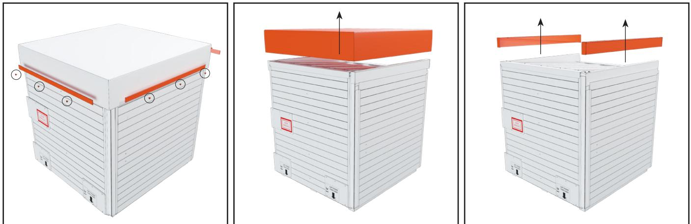
1. Retirez les vis de la couverture de toit et soulevez-la. Soulevez les boîtes en contreplaqué du toit.
