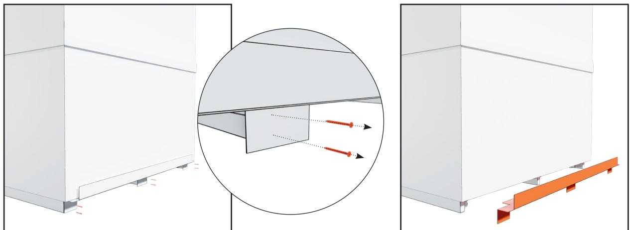
8. Retirez la plaque en métal du dessous arrière du module. La plaque en métal est fixée à l'aide de six vis
