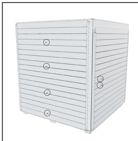
4. Ta bort skyltarna från förpackningen. Ta bort alla skruvar från brädorna. Dessa skruvar håller stödet på plats inuti brädorna.
