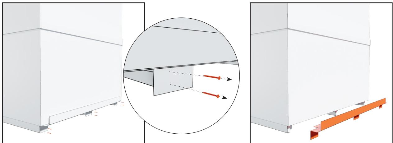
8. Ta bort plåten från modulens bakre nedre kant. Plåten är fäst med sex skruvar.
