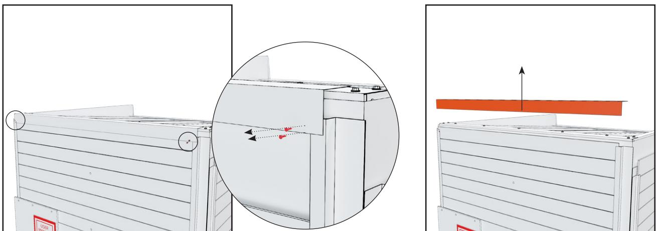
2. Retirez la plaque en métal du bord supérieur avant du toit. Elle est fixée à l'aide de deux vis à chaque extrémité.
