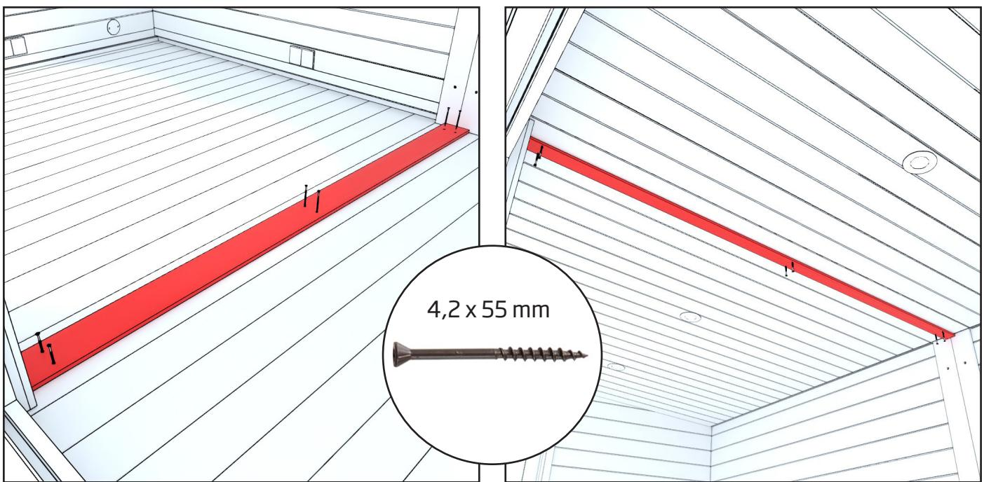
7. Posizionare la striscia di copertura sul pavimento tra i moduli e fissarla con sei viti. La striscia è dotata di fori preformati.
