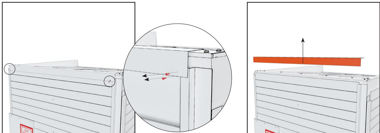
2. Entfernen Sie das Blech an der Vorderkante des Daches. Es ist an beiden Enden mit zwei Schrauben befestigt.
