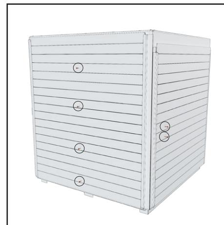
4. Haal de borden uit de verpakking. Verwijder alle schroeven uit de borden. Deze schroeven zorgen ervoor dat de steunen in de borden op hun plaats blijven zitten.
