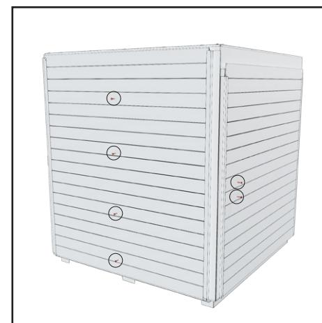
4. Retirez les pancartes de l'emballage. Retirez toutes les vis des planches. Ces vis maintiennent les supports à l'intérieur des planches en place.
