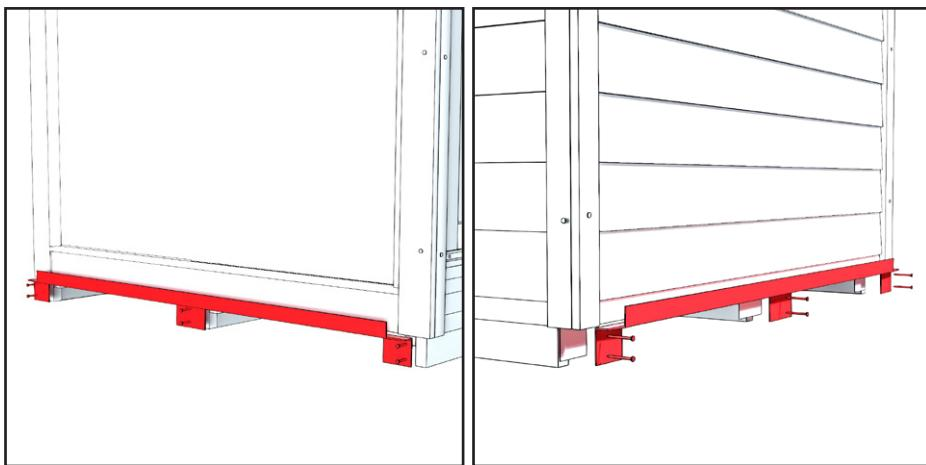
Entfernen Sie das Blech an der vorderen und hinteren Unterkante der Sauna.
