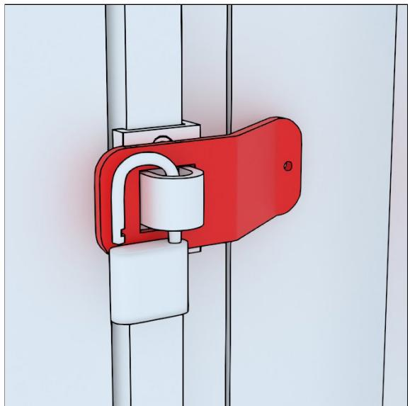
Bastun ska vara låst när den inte används. På det här sättet förhindrar du att dörren öppnas och går sönder till exempel när det är storm.
