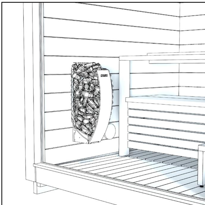
1. Posizionare le pietre della stufa della sauna. Per istruzioni più dettagliate, consultare il manuale incluso nell'imballaggio della stufa della sauna.
