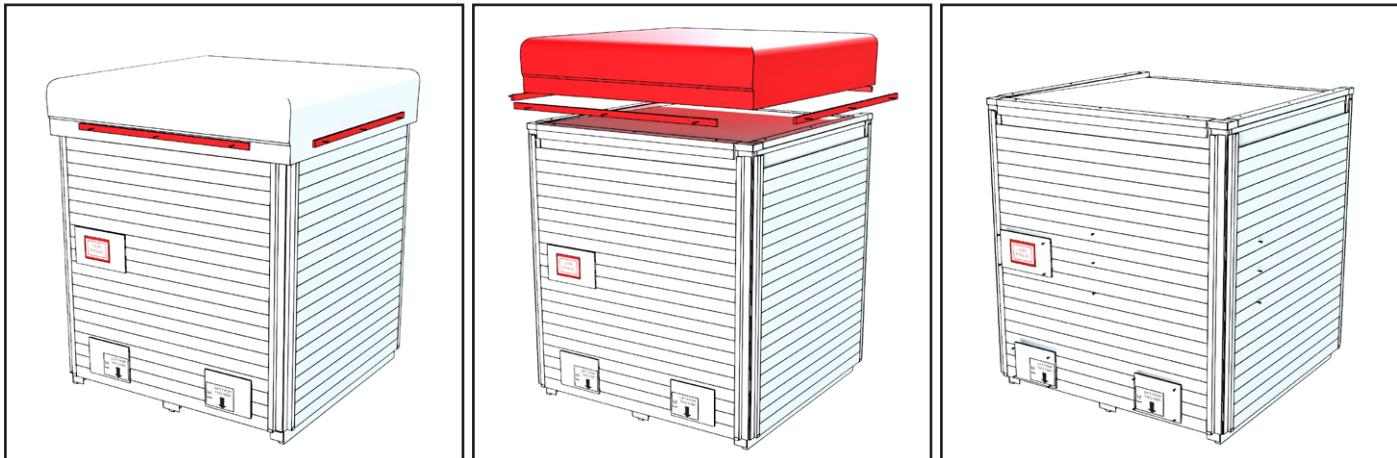
Entfernen Sie die schützenden Abdeckleisten rund um die Sauna und heben Sie die Schutzhülle ab. Lösen Sie die Schilder und Schrauben von der Schutzverkleidung.
