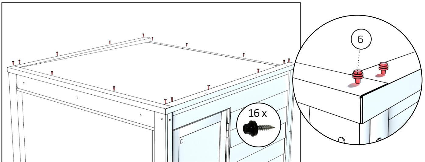
Fäst takplåtens kanter med nya takskruvar. Totalt 16 st.
