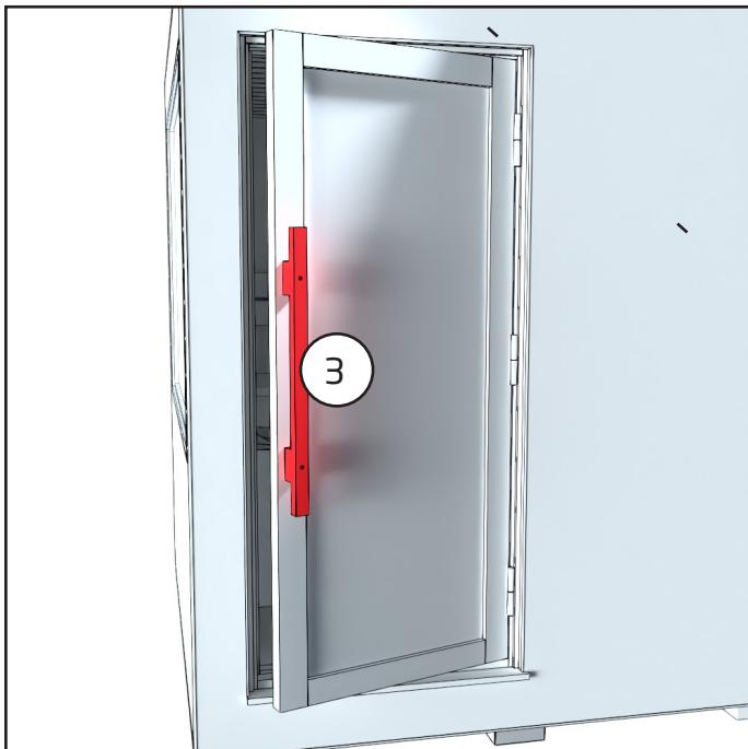
Kiinnita kähava kahdella ruuvilla oveen. Ovessa on reiät valmiina ruuveille.
