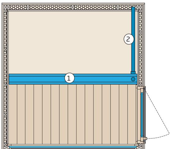
1. La gouttière sous le plancher mène l'eau dans un tuyau en PVC.
