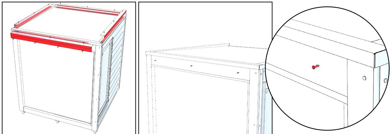
Verwijder de L-vormige metalen platen van de bovenkant van de sauna. De platen zijn met schroeven bevestigd aan de bovenkant en aan de plaat aan de voorkant van de sauna. Steek de schroeven opnieuw in de voorste wand, waar u de afdekking had verwijderd.
