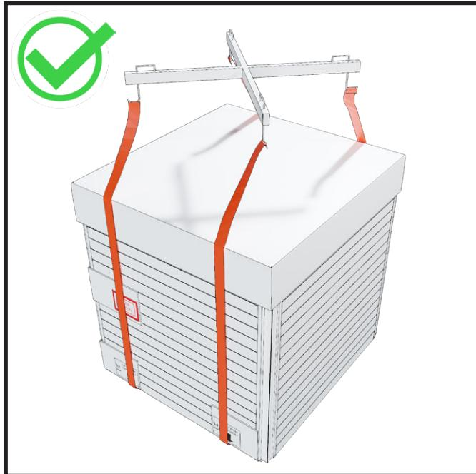
Legen Sie die Gurte von der Vorderseite des Moduls ausgehend zur Rückseite.
