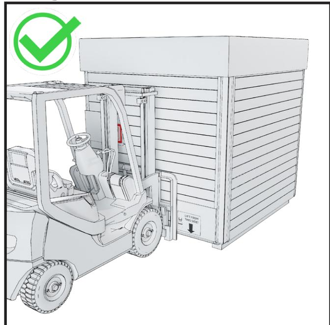
Placez les fourches du chariot élévateur sous le module par l'avant de celui-ci.
