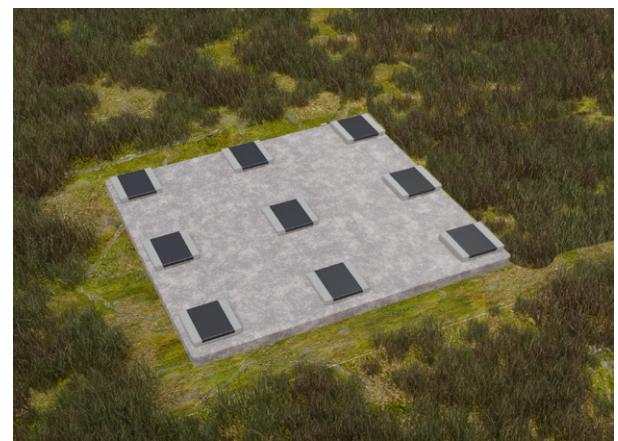
We raden aan om onder de modules betonplaten op de harde oppervlakte te plaatsen, zodat de modules verhoogd worden en om deze platen over de volledige breedte te bedekken met dakbekleding (bitumen-roofing).
