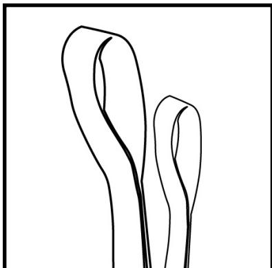
1. Des sangles de levage (recommandé lorsque les modules sont levés pour être installés à l'emplacement définitif).
