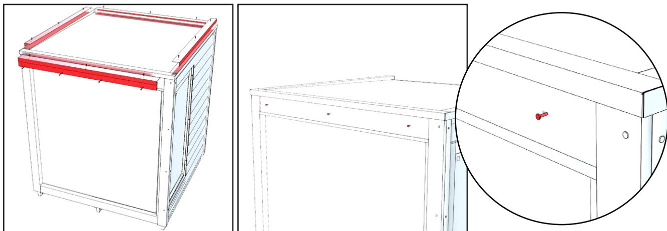
Poista saunan katolla olevat L-profiilin pellit. Pellit ovat laitettu ruuvilla kiinni päältä ja saunan etuosassa olevasta laudasta. Laita ruuvit takaisin etuseinälle samaan kohtaan josta suoja poistettiin.
