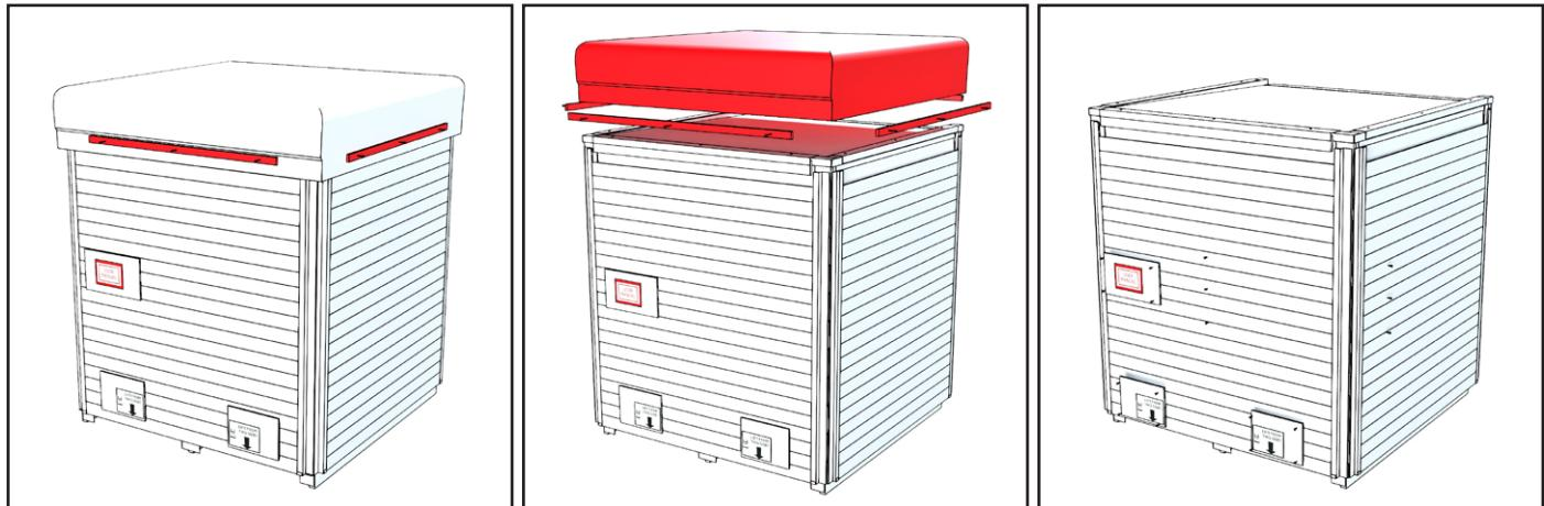
Poista saunan ympärillä olevat suojahupun listat ja nostaa suojaapussi pois. Irroita suojalaudoituksesta olevat kyltit ja ruuvit.
