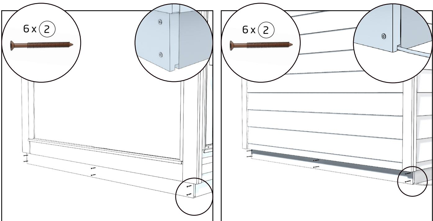
3. Bringen Sie zum Schluss die Sockelleisten an den vorderen und hinteren Transportstützen mit 6 braunen Terrassenschrauben pro Sockelleiste an.
