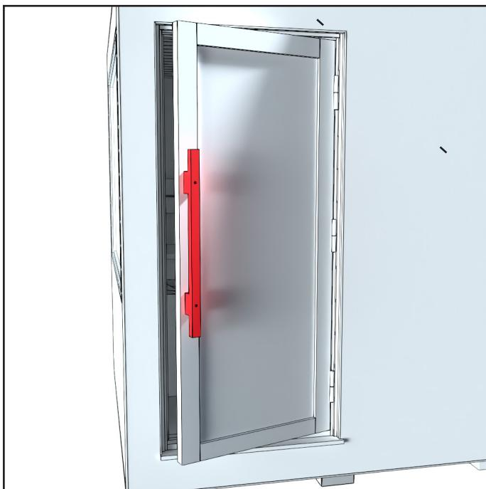
Fissare la maniglia con due viti alla porta. La porta è provvista di fori per le viti.
