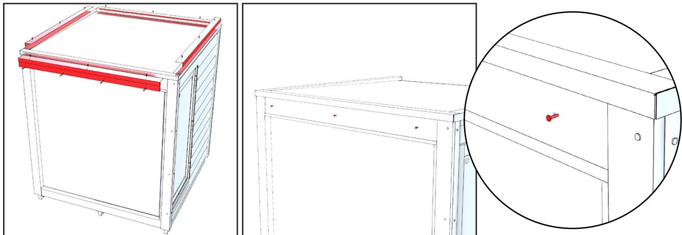
Enlevez les plaques en métal de profilé en L sur le toit du sauna. Les plaques sont fixées avec des vis par le haut et à la planche à l'avant du sauna. Remettez les vis dans le mur avant aux mêmes endroits où le couvercle a été retiré.
