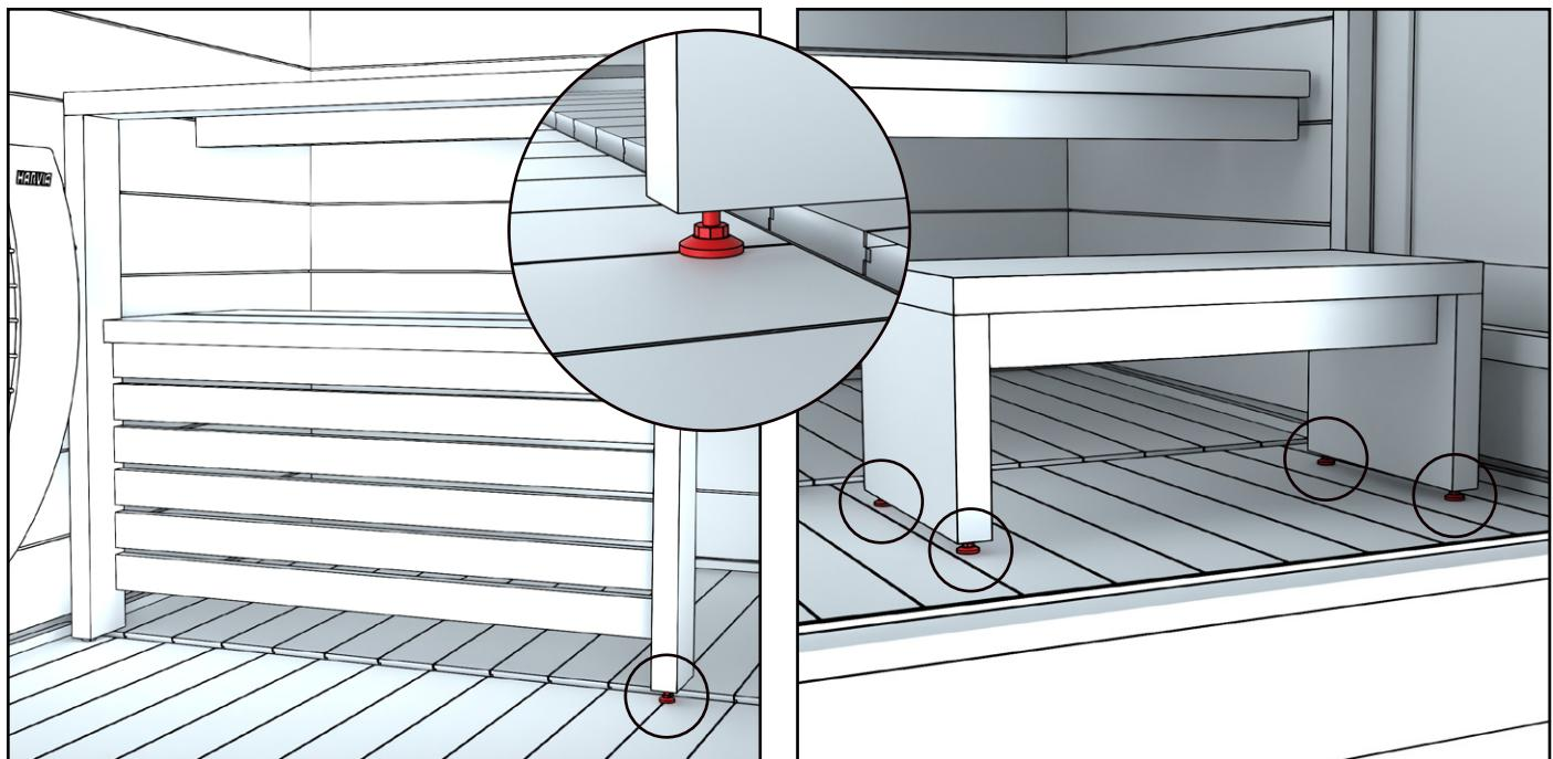
Serrez fermement le pied réglable de la balustrade contre le sol. Le pied réglable du côté du bord du mur est déjà serré. Mettez le tabouret à nouveau en réglant les pieds réglables en fonction de la pente du sol.
