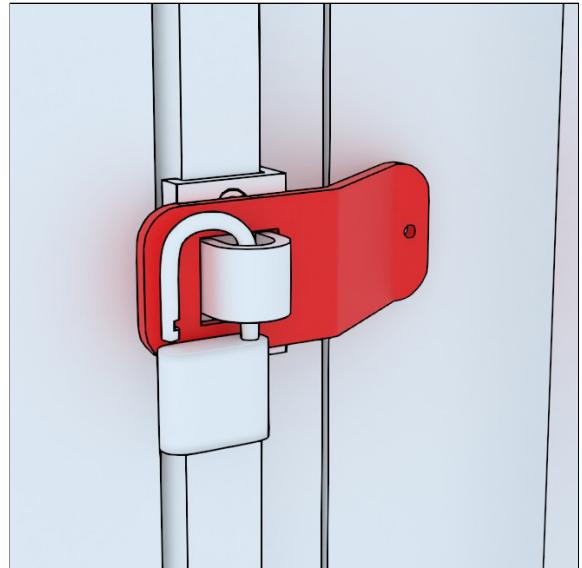
La porte du sauna doit être verrouillée lorsqu'il n'est pas utilisé afin d'empêcher qu'elle ne s'ouvre et se brise en cas de tempête, par exemple.
