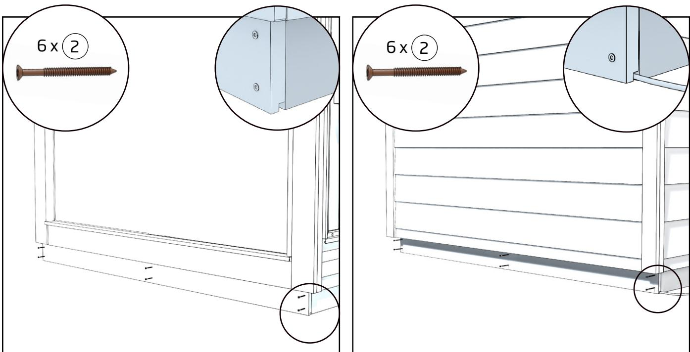
3. Asenna sokkelilaudat kuljetustukiin eteen ja taakse, käytä kiinnittämiseen 6 kpl ruskeita terassiruuveja per sokkelilauta.
