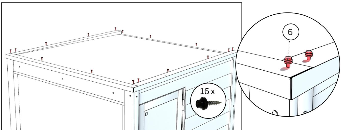
Fixez les bords de la plaque de toit avec de nouvelles vis de toiture. 16 pièces en tout.
