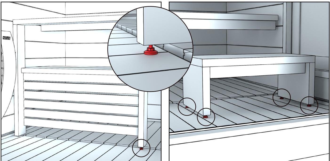
Stringere saldamente la base regolabile del parapetto sul pavimento. Sul lato della parete del bordo, il piede regolabile è già fissato. Regolare i piedini dello sgabello in base alla pendenza del pavimento per raddrizzarli.
