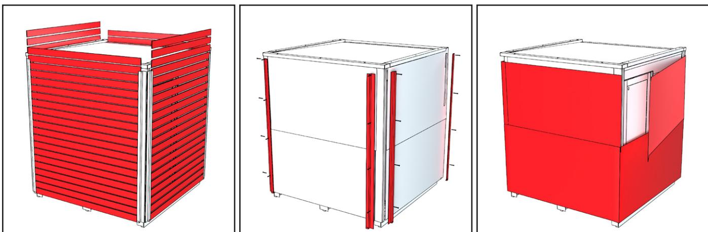
Entfernen Sie die Schutzleisten und lösen Sie die Eckbleche (8 Stück) von den Kanten der Sauna. Entfernen Sie den weißen Verpackungsschutz um die Sauna.
