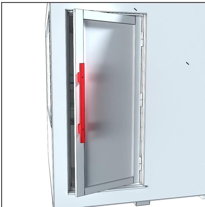
Fixez la poignée à la porte à l'aide de deux vis. Des trous sont déjà prépercés pour fixer les vis dans la porte.
