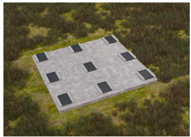
Vi rekommenderar att du på det hårda underlaget under bastun placerar nio betongplattor som extra förhöjning samt takpapp (bitumenpapp) på plattorna.
