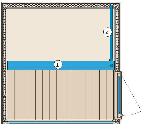
1. La grondaia sotto il pavimento porta l'acqua al tubo in PVC.
