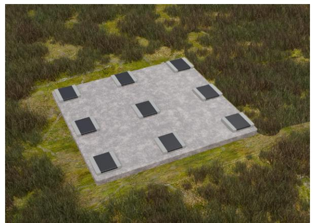
Suosittelemme asettamaan kovan alustan päälle betonilaattoja lisäkorotukseksi sekä laattojen päälle kattohuopaa (bitumihuopa) laatan leveydelle.
