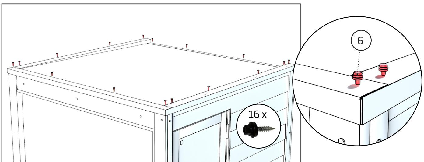
Fissare i bordi della lamiera del tetto con nuove viti. 16 pezzi.
