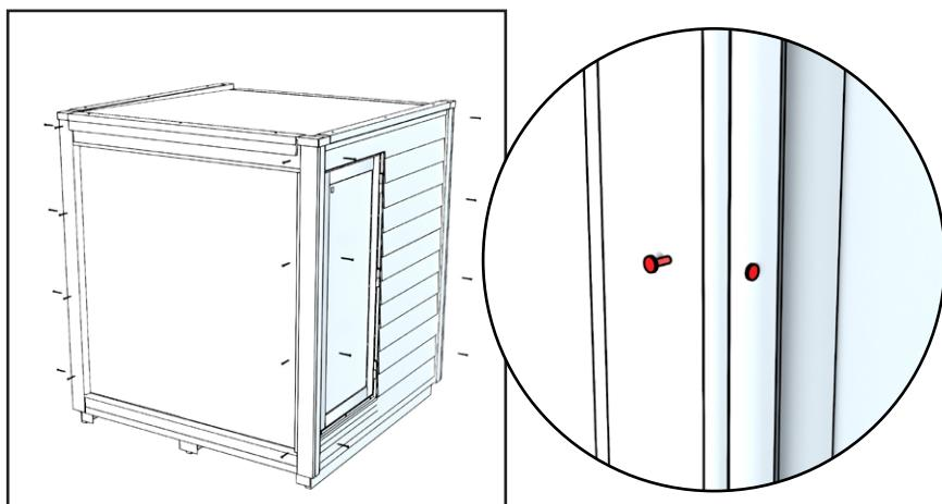
Remettez les vis qui ont servi à fixer les plaques d'angle en métal dans les bandes d'angle.
