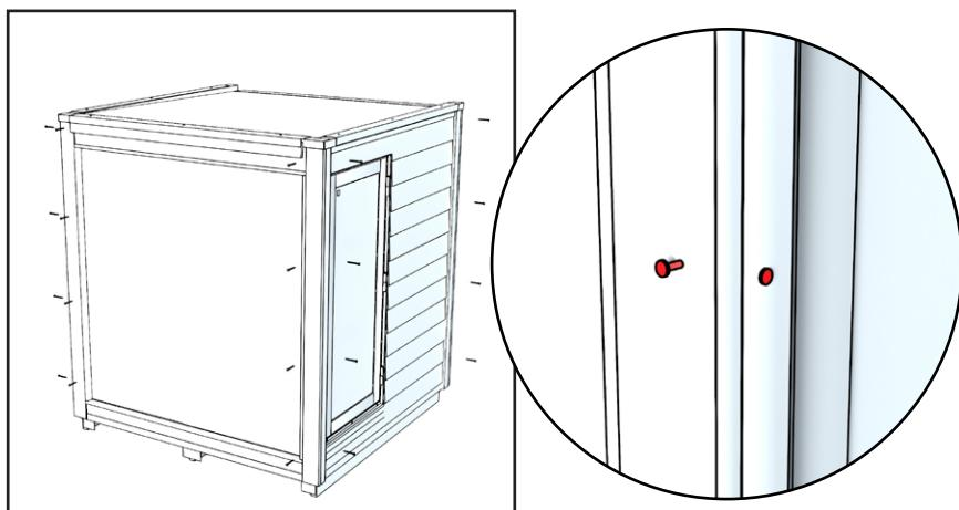
Setzen Sie die Schrauben, mit denen die Eckbleche befestigt wurden, wieder in die Eckleisten ein.
