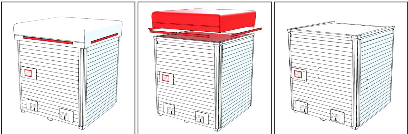
Retirez les bandes de protection autour du sauna et soulevez la bâche de protection. Détachez les pancartes et les vis du bardage de protection.
