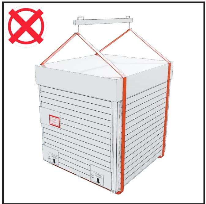
Ne levez jamais les modules avec des sangles placées d'un côté à l'autre.
