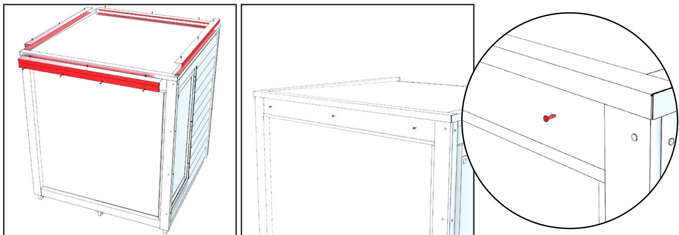
Togliere le lamiere a L dal tetto della sauna. Le lamiere sono attaccate con le viti dall'alto e al bordo nella parte anteriore della sauna. Rimettere le viti nella parete anteriore negli stessi punti in cui è stato rimosso il coperchio.
