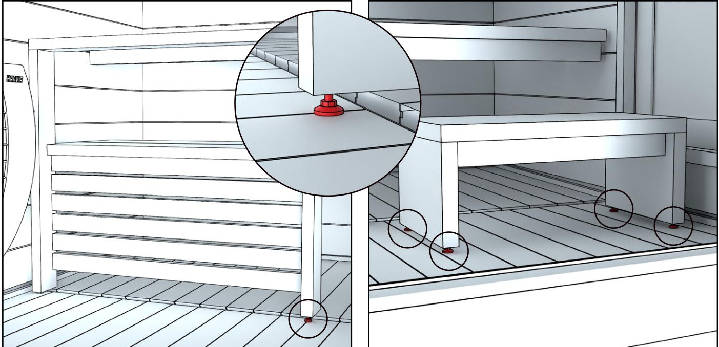
Ziehen Sie den verstellbaren Fuß des Geländers fest gegen den Boden. Auf der Wandseite der Kante ist der verstellbare Fuß bereits fest eingestellt. Stellen Sie die Stellfüße des Tritthockers entsprechend der Bodenneigung so ein, dass sie gerade stehen.
