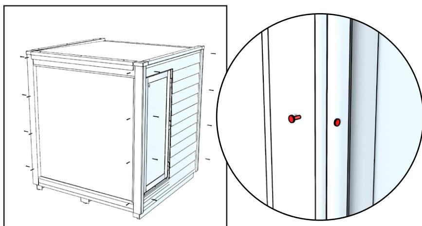
Laita ruuvit, joilla kulmapellit oli kiinnitetty, takaisin kulmalistoihin.
