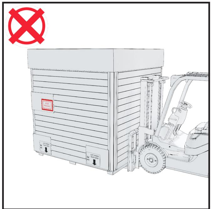
Fahren Sie den Gabelstapler niemals von der Seite unter das Modul. Dies führt zur Beschädigung des Moduls.
