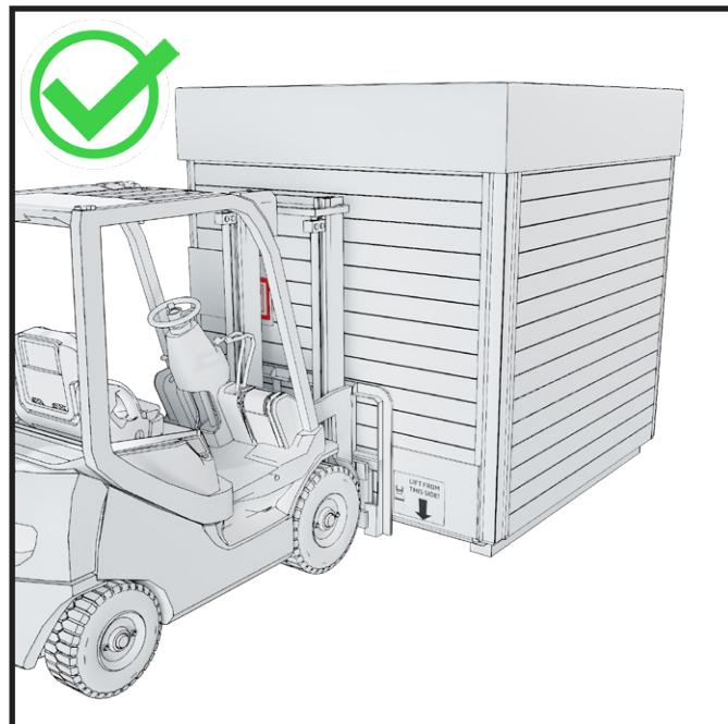
Guidare il carrello elevatore sotto il modulo dalla parte anteriore.
