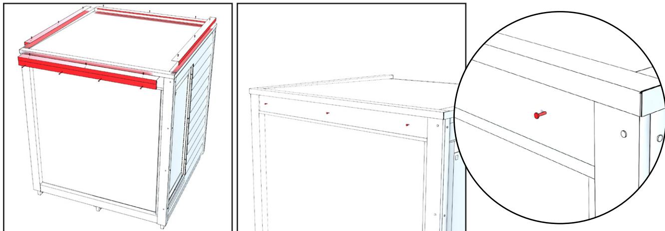
Ta bort L-profilens plåtar på bastuns tak. Plåtarna är fästa med skruvar ovanifrån och från brädan i framsidan av bastun. Sätt tillbaka skruvarna på framsidan på samma ställe där skyddet togs bort.
