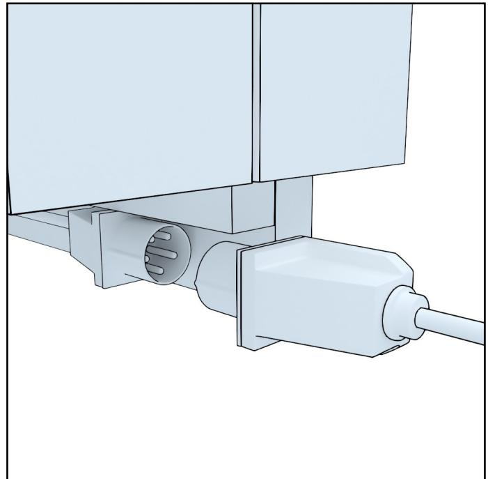
2. Branchez l'alimentation principale du sauna. Le raccordement se trouve à l'arrière du sauna, du côté du poêle.
