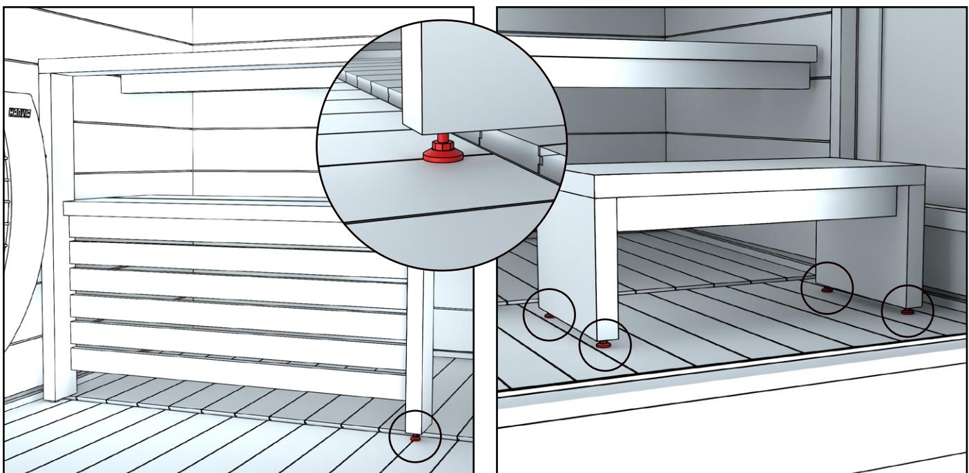
4. Kiristää kaiteen säätöjalka tiukaksi lattiaa vasten. Reunassa seinän puolella säätöjalka on valmiiksi säädetty tiukalle. Säädä nousuaskelman säätöjalat lattiakaodon mukaan suoraksi.
