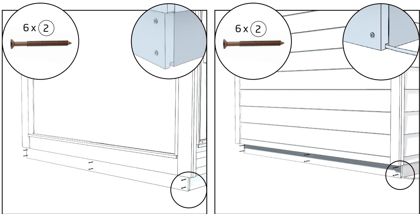
3. Installez les planches de recouvrement sur les supports de transport à l'avant et à l'arrière à l'aide des 6 vis-terrasses brunes.
