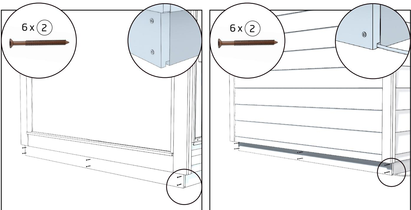
3. Montera sockelbrädorna i de främre och bakre transportstöden, använd 6 st. bruna terrasskruvar per sockelbräda till monteringen.
