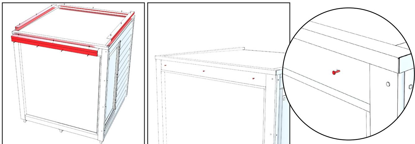
Entfernen Sie die L-Profil-Bleche auf dem Saunadach. Die Bleche sind mit Schrauben von oben und an der Leiste an der Vorderseite der Sauna befestigt. Bringen Sie die Schrauben wieder an der Vorderwand an den Stellen an, an denen die Abdeckung entfernt wurde.
