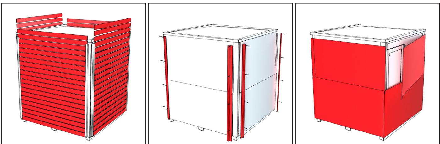
Soulevez les planches de protection et détachez les plaques d'angle en métal (8 pièces) des bords du sauna. Retirez d'emballage de protection blanc entourant le sauna.
